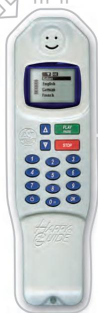
**SD card**, con memoria fino a 32 G byte, estraibile definisce tutti i contenuti della vostra audioguida e i modi di funzionamento. Riconosce fino a 990 didascalie in 16 lingue per un totale di 64 ore di testo parlato.
